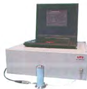
図9. 誘電率測定装置
