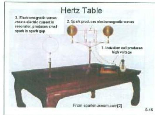
Hertzian dipole は共振器とアンテナが集成された構造で、天才実験研究家 Hertz の面目躍如たるデバイスである。
