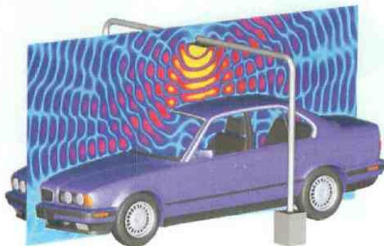
図 6 自動車のアンテナから空間に出る電波の三次元的分布
